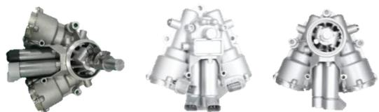
Gear Actuator는 변속기 소프트웨어의 제어를 받아 일정한 조건에서 변속기의 기어 단수를 자동으로 변경하는 제품입니다. 프리 셀렉트, 이중 치합 방지, 기준점 검출 등의 기술이 적용됩니다.
