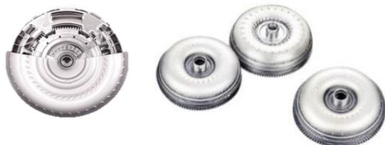
Torque Converter는 내연기관 차량의 엔진 토크를 별도의 클러치 유체의 작용을 통해 증폭시켜 자동변속기로 전달함으로써 내연기관 차량의 출력과 연료 효율을 결정하는 구동계 핵심부품입니다. 연비 개선을 위한 록업 클러치, 진동 흡수를 위한 댐퍼 등의 기술이 적용됩니다.
